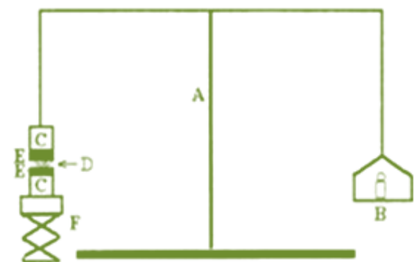
(A) Modified Balance, (B) weight (C) Glass vial (D) Gel (E) mucous membrane (f) Height adjustable pan
